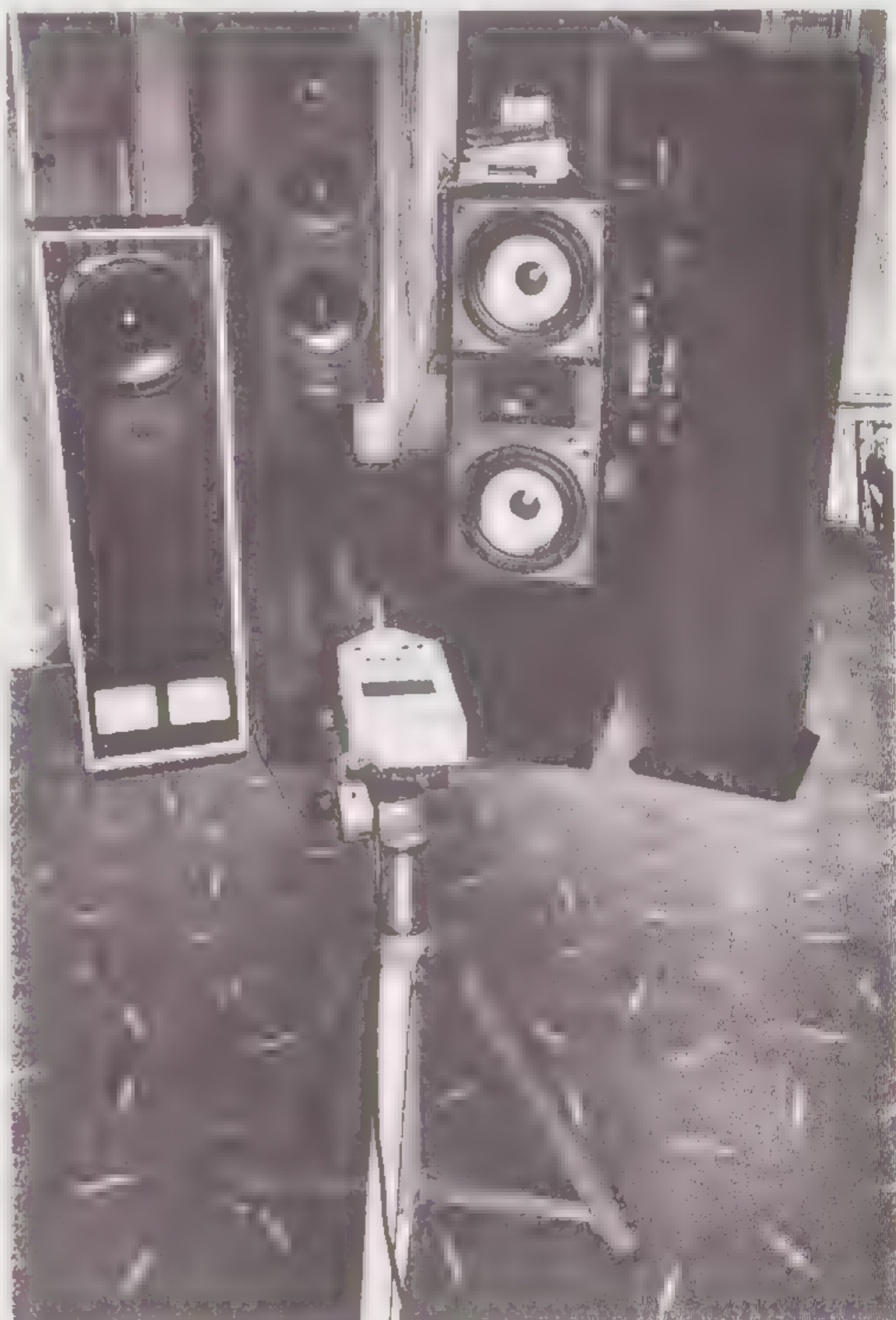
De meetopstelling met de CEL meetmicrofoon. De luidsprekers staan er slechts voor de foto, in werkelijkheid stond er per meting slechts een luidspreker.
